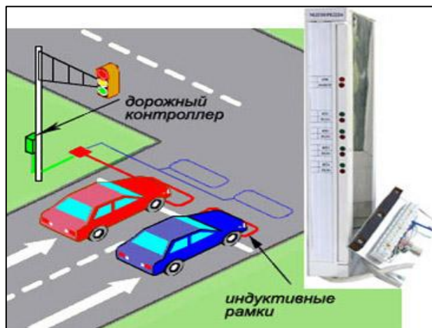
Рисунок 32 – Механизм работы электромагнитного детектора
